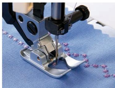
Il piedino per Candlewicking ha una profonda scanalatura sul lato inferiore per un facile trasporto sopra una cucitura molto fitta.
